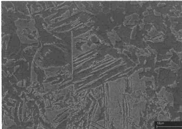
Figura 6.2: Microestrutura da amostra TA-20°C/s, obtida por MEV, mostrando as fases formadas: ferrita acicular, ferrita intragranular e bainita.
