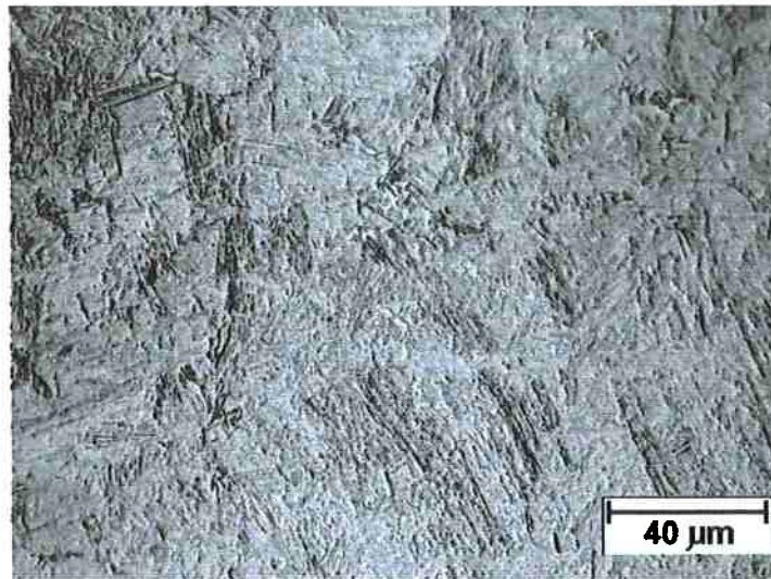
Figura 5.15: Microestrutura obtida para amostra TB-40°C/s: martensita.
